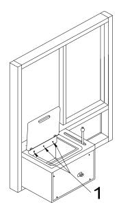
REMOVE THE TOP LID. 3 SCREWS LOCATED UNDER THE DRAWER LID.
