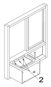
REMOVE THE 3 SCREWS LOCATED BEHIND THE HINGE PLATE. (CUT THE SILICONE SEALANT ARROUND THE OUTSIDE EDGE OF THE DRAWER FRAME.)
